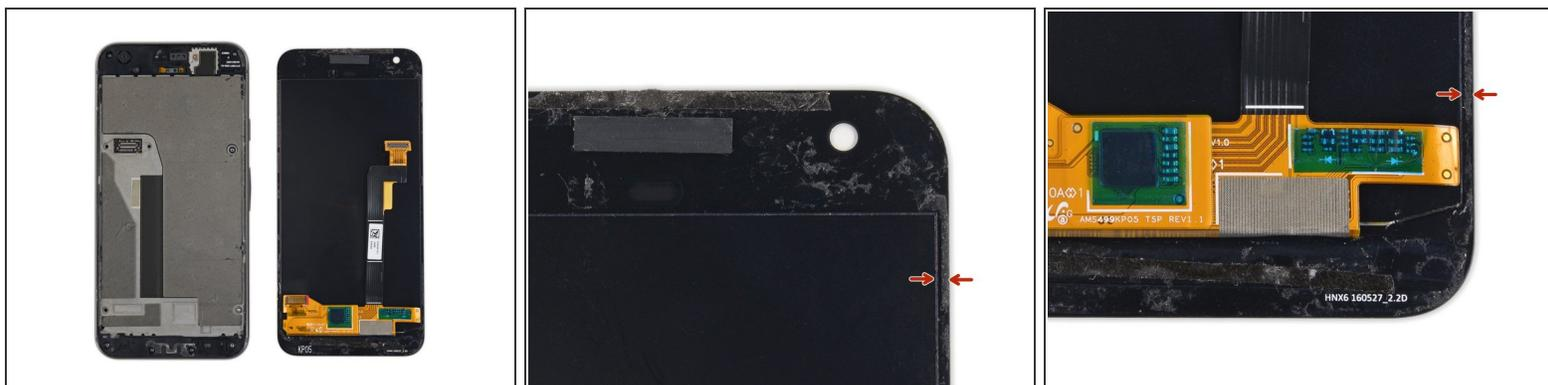
**i** In den folgenden Schritten wirst du die Klebeverbindung zwischen Bildschirmglas und Rahmen des Pixels auftrennen.
