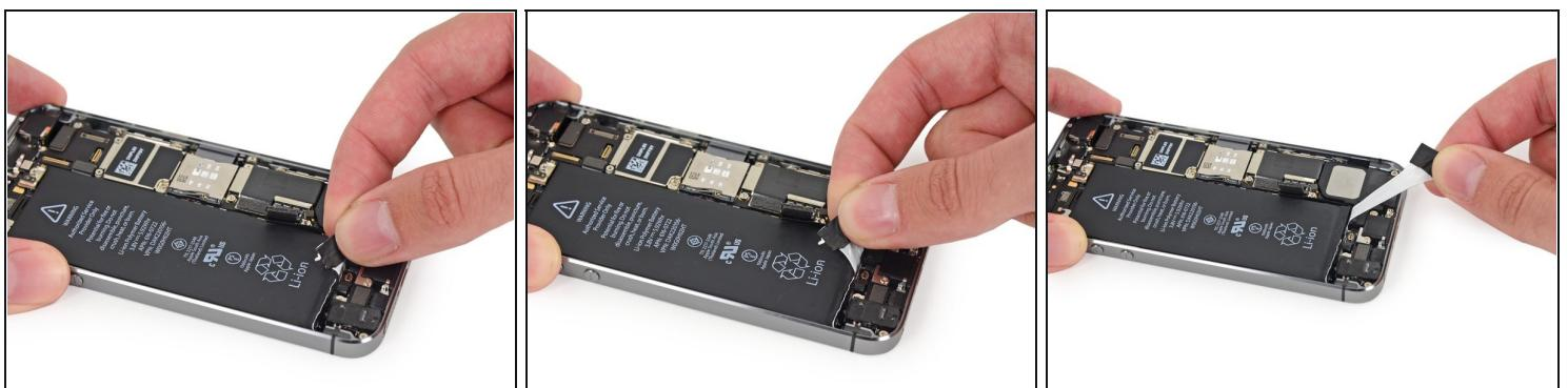
⚠ 在这一过程中尽量保持粘合条平整不弯曲，弯曲的粘合条容易粘在一块而损坏，这样就不会完好的拉出来
