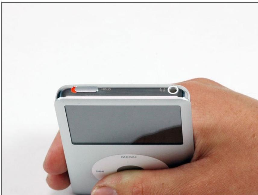
ⓘ Apple a conçu ses nouveaux iPods pour être très difficiles à démonter sans détruire les composants majeurs. La combinaison des plaques métalliques, du support en métal et des 13 (oui, 13) clips en métal en fait un des iPod les plus difficiles à démonter.
