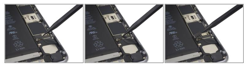
Use a ponta fina de uma espátula para desconectar o conector da bateria levantando-o da placa lógica em sentido vertical.
