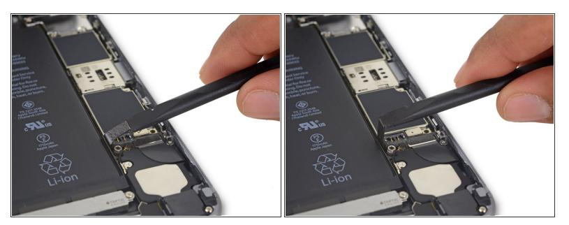
Empurre o conector da bateria na direção contrária à placa lógica até que ele fique separado de seu soquete, evitando, assim, uma conexão acidental à bateria enquanto você trabalha.
