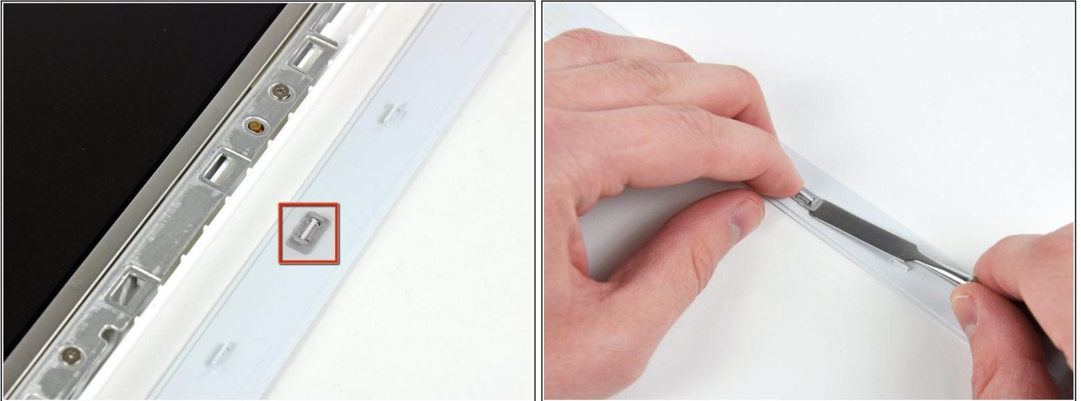
**i** Parfois, lors du retrait du cadre de l'écran, les clips de retenue, qui devraient rester pris dans les fixations de l'écran LCD, partent avec le cadre de l'écran. Suivez cette étape et la suivante pour retransférer les clips sur la fixation de l'écran LCD.
