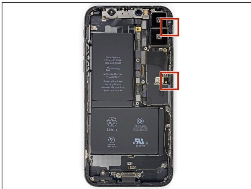
⚠ Há cabos sensíveis ao longo da borda direita do iPhone. **Não insira a palheta aqui**, pois isso pode danificar os cabos.
