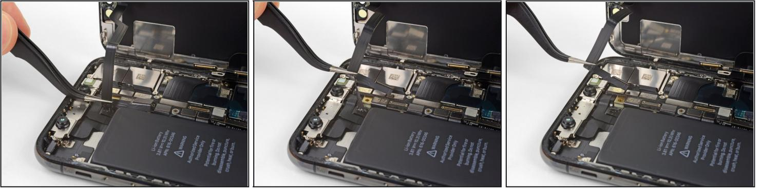
ⓘ O cabo conector flex do conjunto de sensores do painel frontal está ligeiramente colado.
